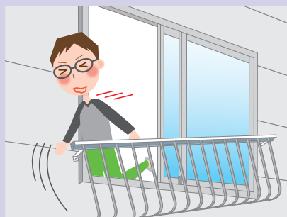
部材・格子のガタつき・はずれを放置したため、寄りかかった際に転落
